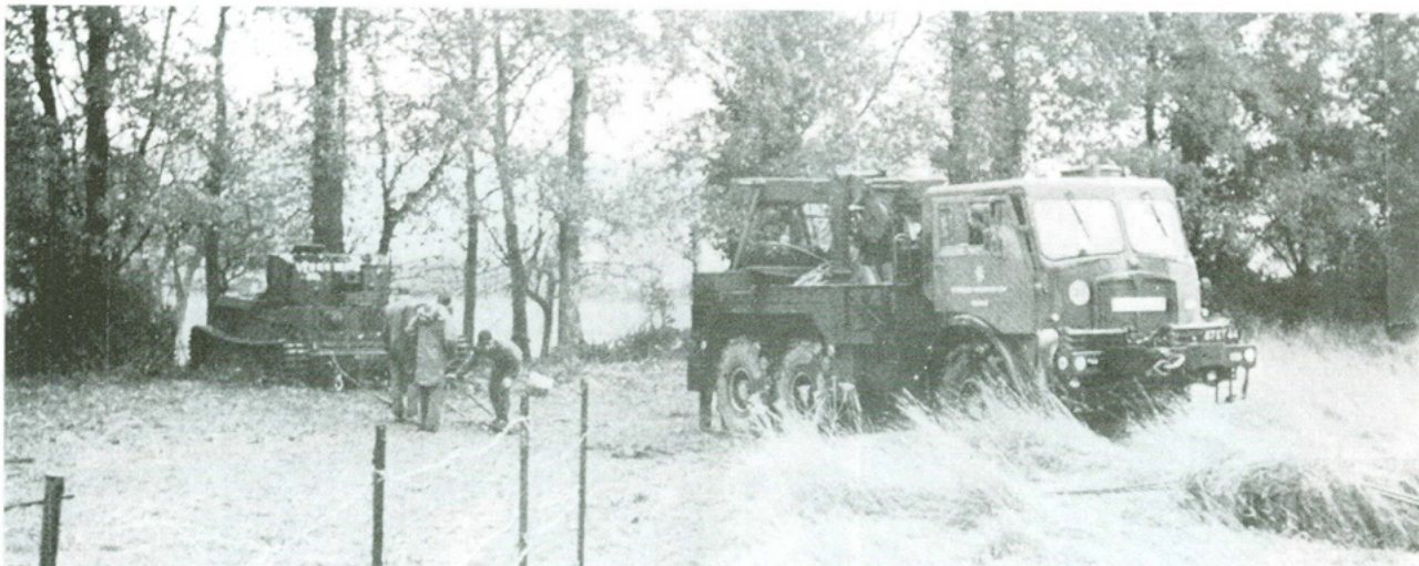
De kabels worden aan de Centaur vastgemaakt; het karwei wordt geklaard door een AEC bergingsvoertuig.
